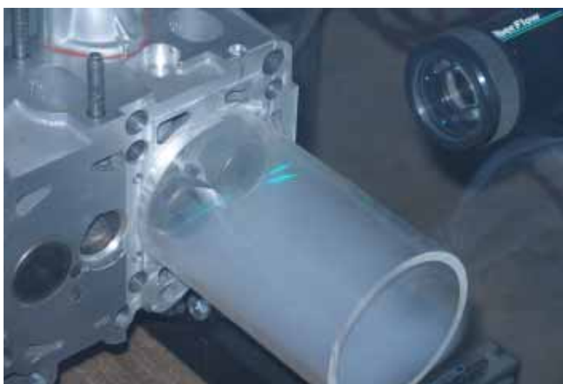
Rys. 3. Widok fragmentu stanowiska w trakcie badań rozkładu prędkości we wnętrzu cylindra za pomocą anemometru laserowego.
